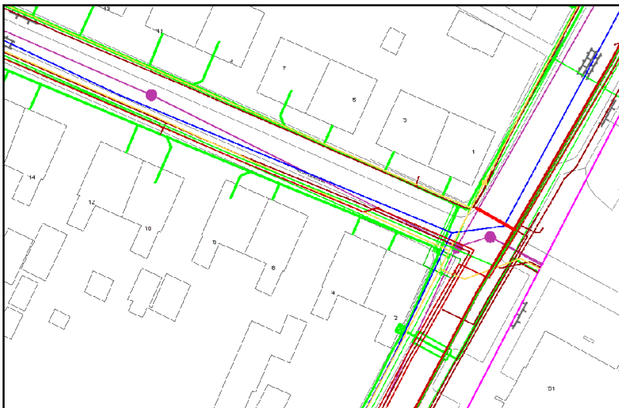
Figuur 2. Uitsnede van de KLIC-melding, waarbij elke gekleurde lijn een leiding aangeeft. De leidingen zijn dus met name aan weerszijden van de straat aangelegd (bron: Kadaster).
