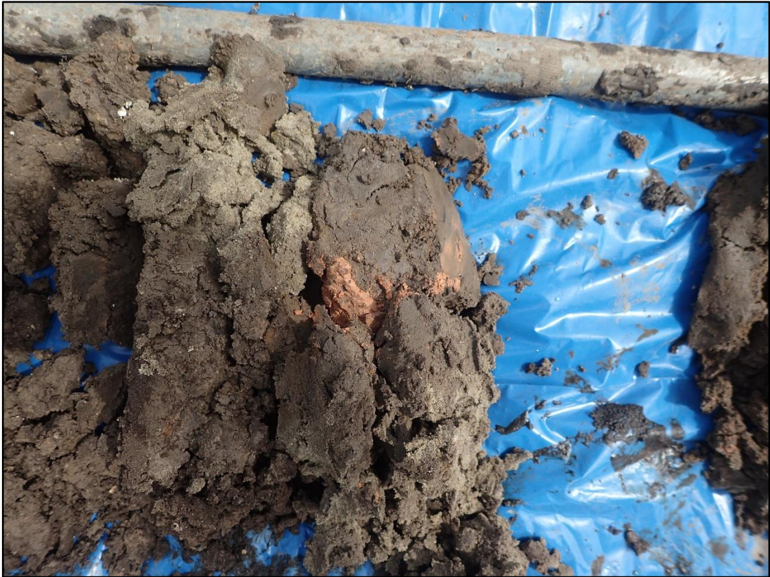
Figuur 2. Een vergraven c.q. verspoeld fragment bouwpuin (baksteen) op circa 50 cm –Mv (boring 2).
