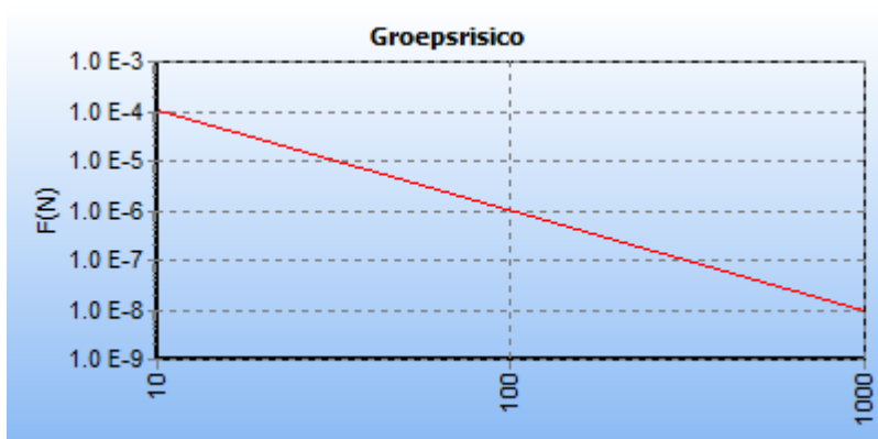
Figuur 5.6 FN curve voor W-524-07 van N.V. Nederlandse Gasunie voor de kilometer tussen stationing 0.00 en stationing 20.00
