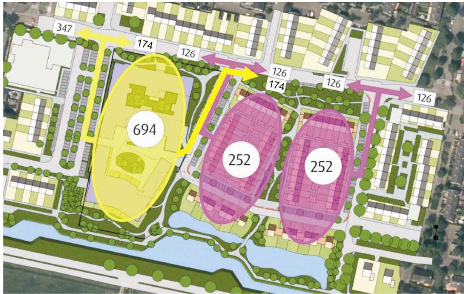
Figuur 3.2: Aanname verdeling toekomstige verkeersstromen en intensiteiten (bron ondergrond: stedenbouwkundig plan gemeente Oud-Beijerland, kenmerk: 4446 - 27-03-2012)
