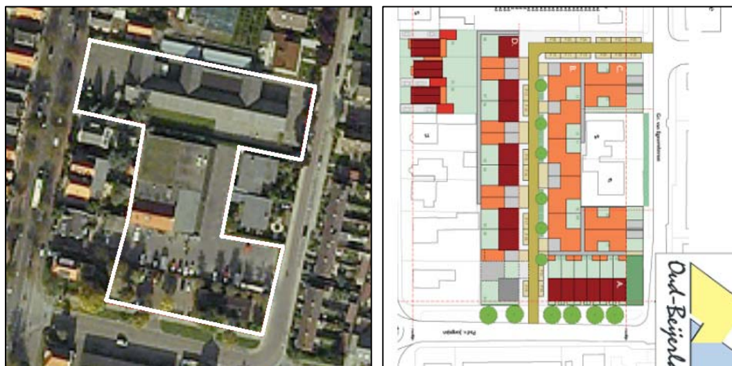
Figuur 5: Huidige situatie (links, schatting circa 95% verhard) Beoogde situatie (rechts, schatting 85-90% verhard).
