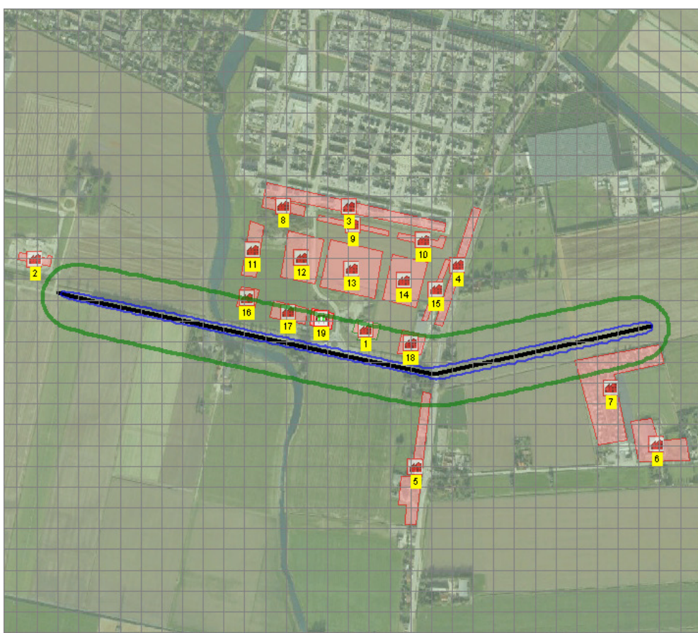
Figuur 3. Plaatsgebonden risicocontouren huidig transport (gridgrootte 50 m)
