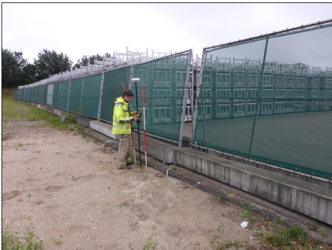
Figuur 10: Het uitzetten van de werkputten met behulp van een dGPS. Met op de achtergrond de genoemde veilingkarren.
