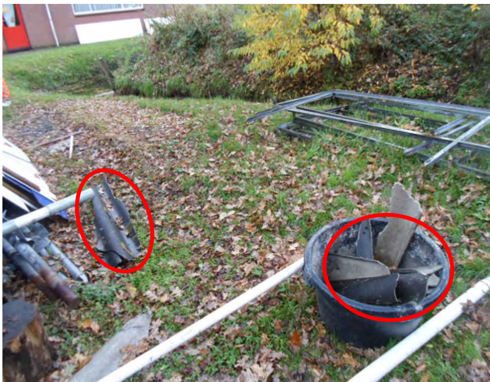
Fotonummer: 2 Omschrijving: Asbestverdacht plaatmateriaal in kuip en op maaiveld
