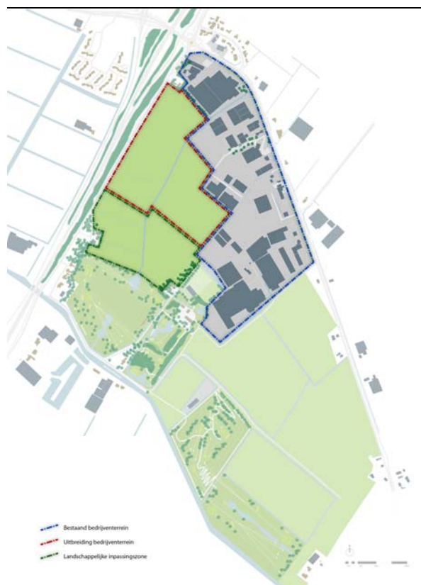
Figuur 2.1 Vlekkplan van het plangebied. In blauw omlijnd het te revitaliseren bedrijventerrein, in rood omlijnd het nieuw te ontwikkelen bedrijventerrein en in groen omlijnd de zone landschappelijke inpassing met eventueel woningbouw (bron: Bosch Slabbers).
