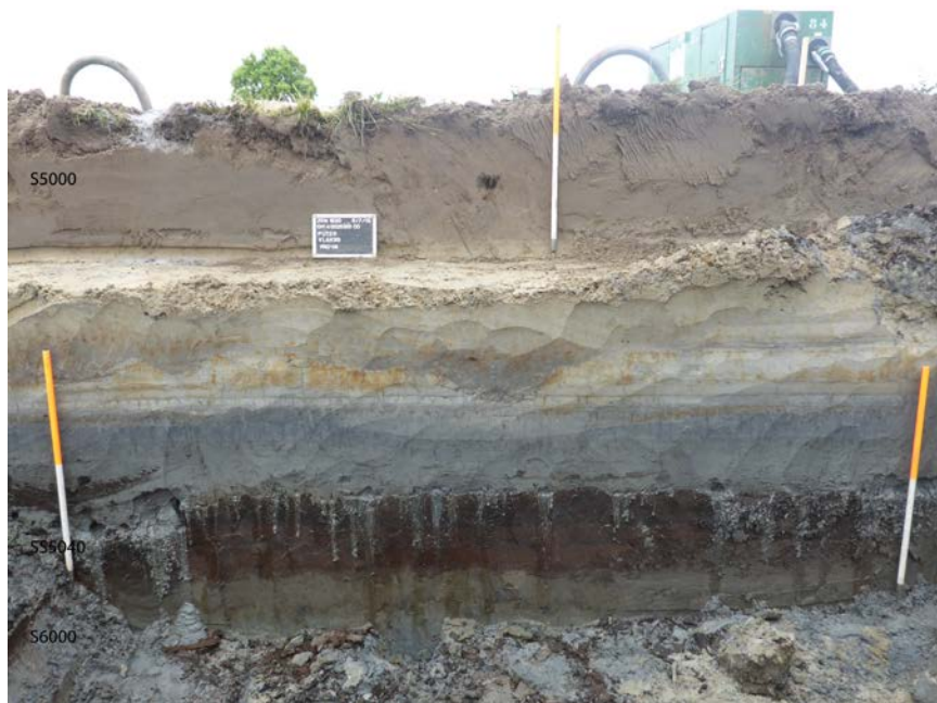
Figuur 8 Bodemopbouw in zone C (profiel 48, put 20). Voor betekenis laagnummers zie tabel 3.
