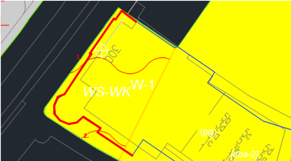
Figuur 4.5 Geveldelen appartementen Jan van Henegouwenweg met overschrijding van de voorkeursgrenswaarde als gevolg van het wegverkeer op de Parallel Boulevard
