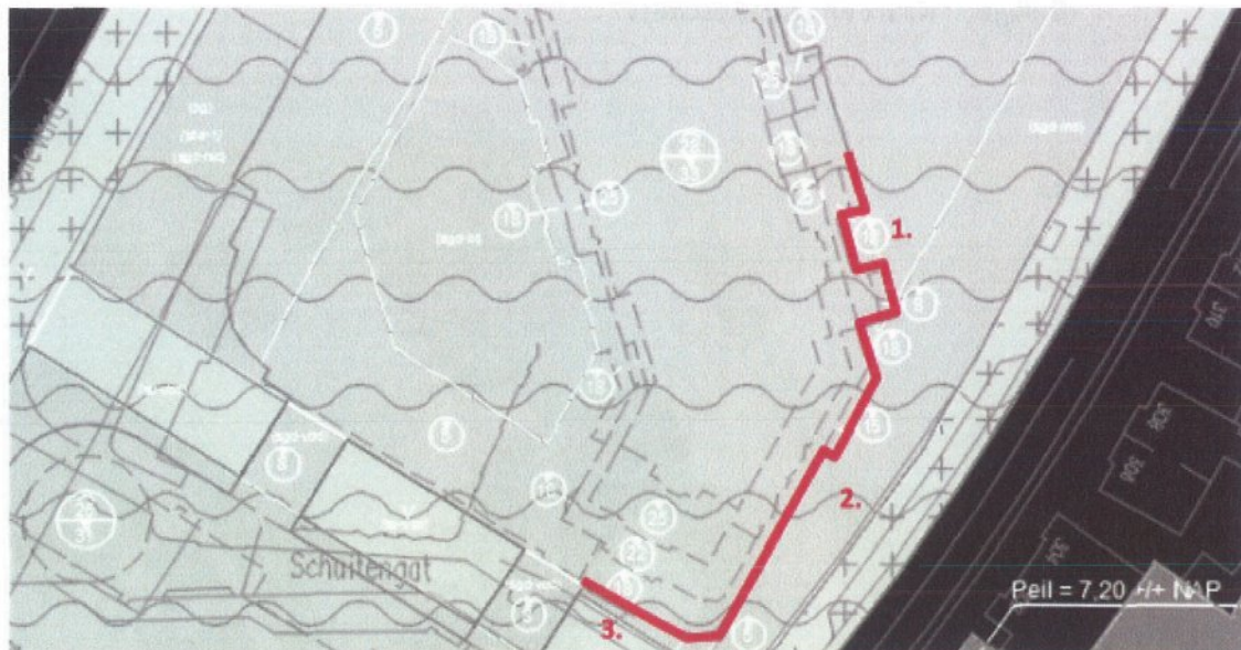
Figuur 2. Geveldelen zuidelijke gebouw Residence; rode lijn zijn geveldelen met hogere waarde (zie figuur 4.1 rapportage)
