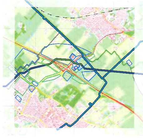
Figuur 5 — Kilometer leiding behorende bij de maximale overschrijding van de FN-curve voor A-560 van N.V. Nederlandse Gasunie, — hoge druk aardgasleiding A560, — overige hoge druk aardgasleidingen.
