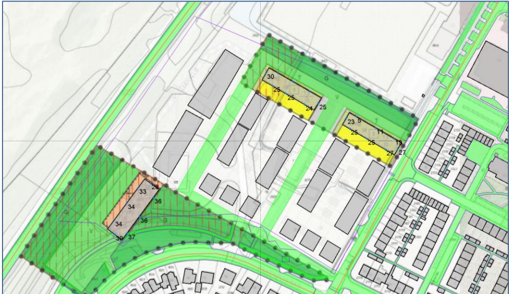
Figuur 3 Hoogst berekende geluidbelasting vanwege de N442 inclusief aftrek artikel 110g Wgh
