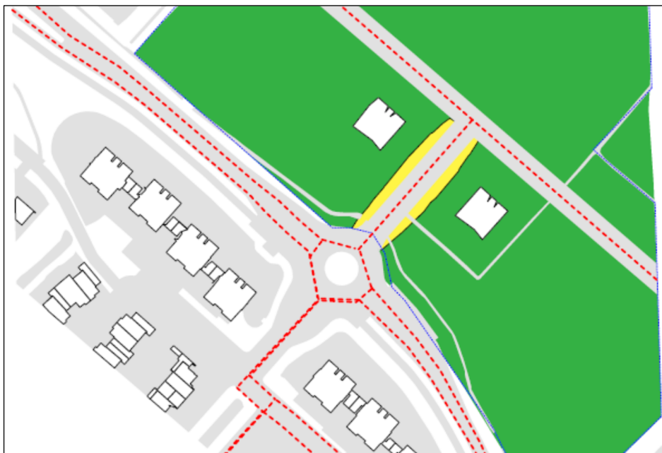
Figuur 5.5: Geluidbelastingen ontsluitingsweg (1.750 mvt/etm, 30 km/u, standaard asfalt)
