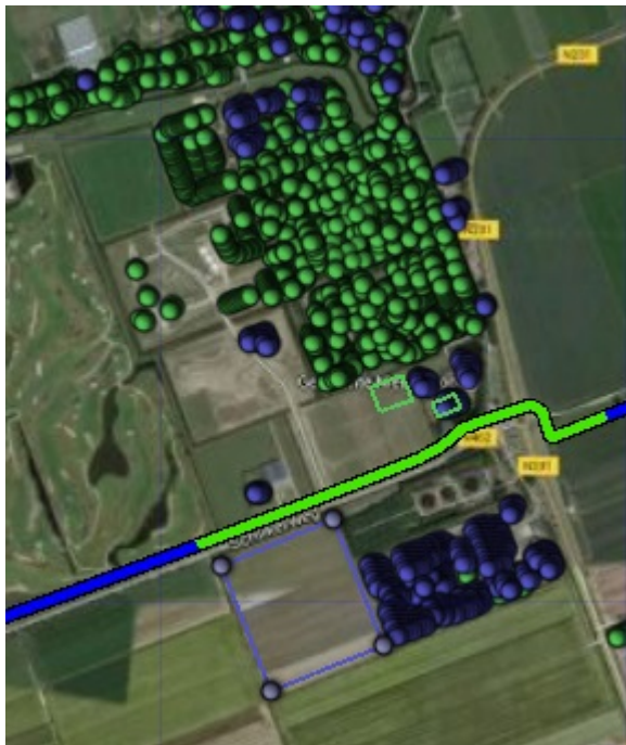
Figuur 4.4: Kilometer leiding in kern Nieuwveen behorende bij de maximale overschrijding van de FN-curve voor leiding-W-529-17-deel-1 van N.V. Nederlandse Gasunie.
