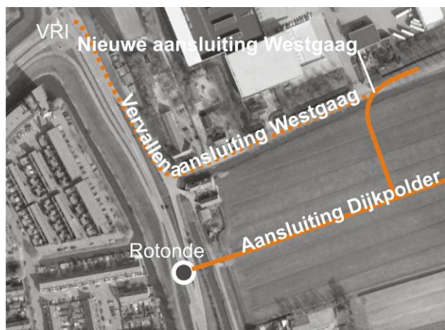
Figuur 7.4: Nieuwe aantakking Dijkpolder op de Maasdijk
