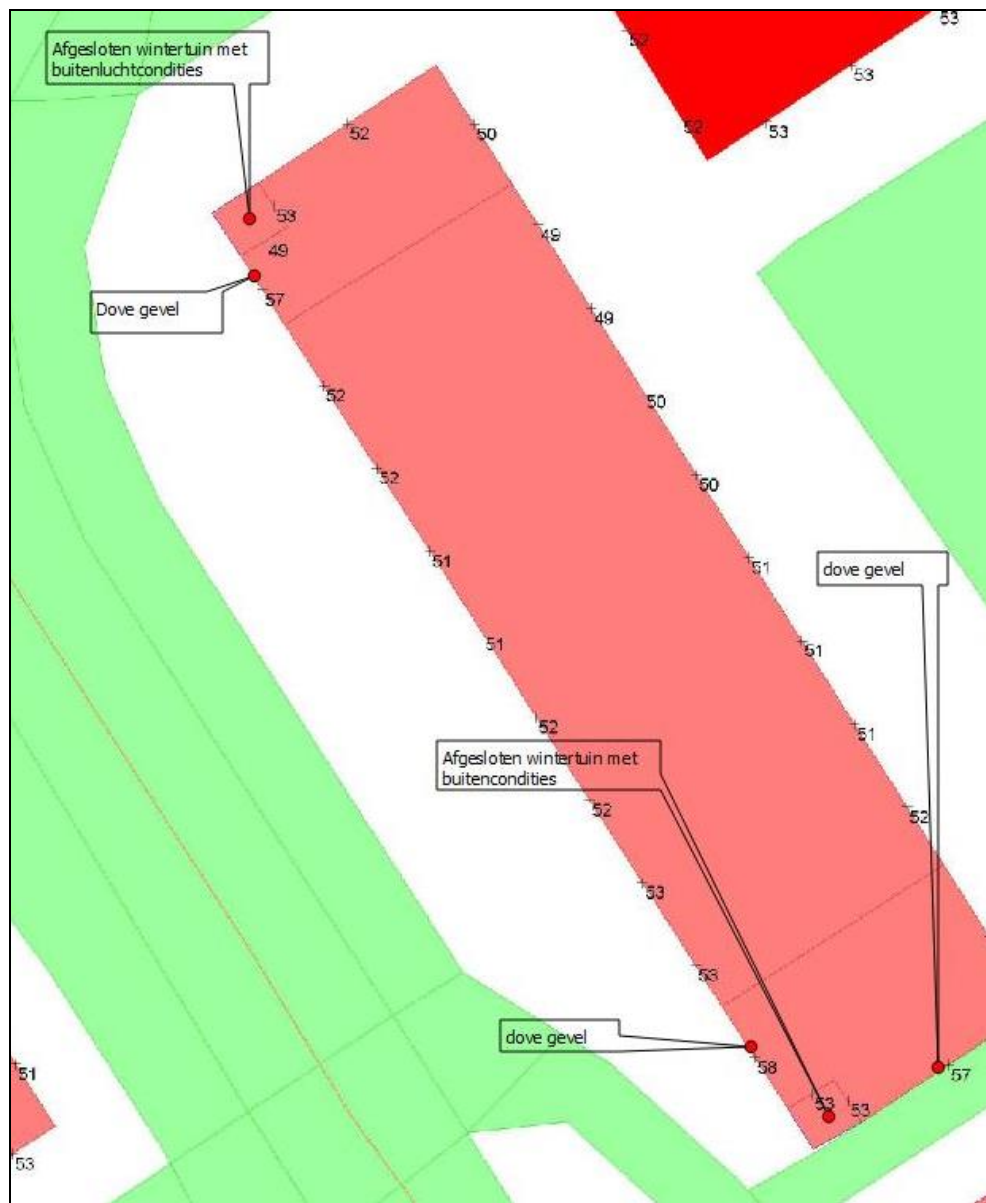
Figuur 9 Posities van de te treffen maatregelen dove gevel en afgesloten buitenruimte met buitenluchtcondities (wintertuin)
