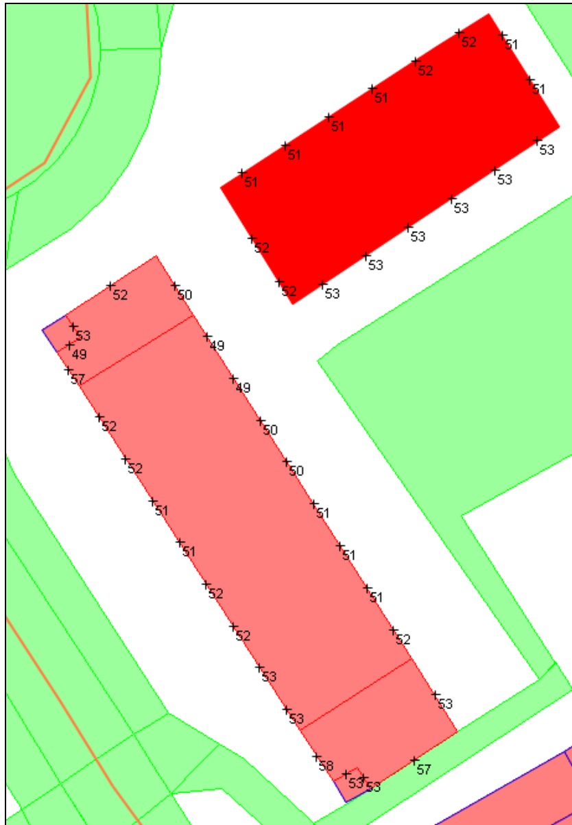
Figuur 8 Hoogst berekende geluidbelasting vanwege de A4 bij realisatie van een, door een 1,5 meter hoog scherm afgeschermd buitenruimte inclusief aftrek ex artikel 110g Wgh
