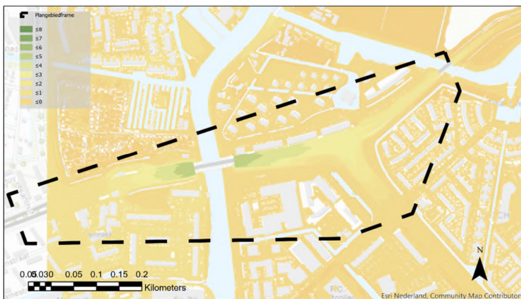
figuur 2-4: Puntmetingen toegepast voor het DTM-model, hoogte aangegeven in meters t.o.v. NAP
