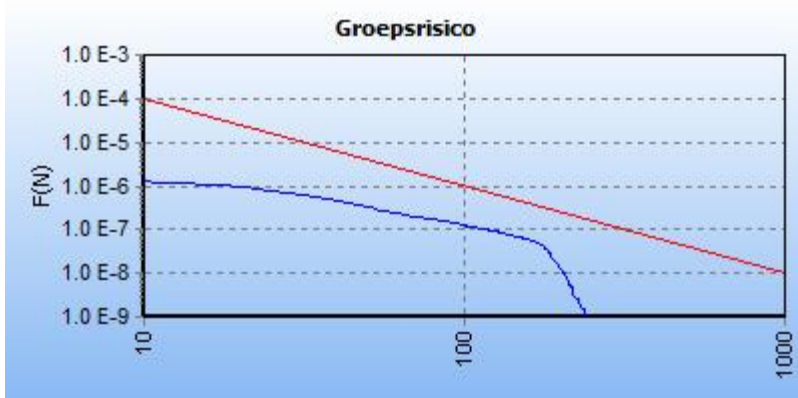
5.3 Figuur 5.3 FN curve voor 7898_leiding-W-515-05-deel-1_incl verl van N.V. Nederlandse Gasunie voor de kilometer tussen stationing 1620.00 en stationing 2620.00
