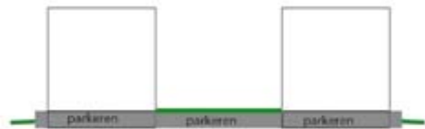
schema (halfverdiept) parkeren onder dek. Tussenruimte maakt een integraal onderdeel uit van de groene inrichting van de buitenruimte en is openbaar toegankelijk.
