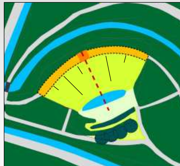
Zonering voor het afvlakken van de bovenrand van het openluchttheater: Boven aan het talud een rand van ca. 2m breed horizontaal maken. In het midden is een opstelplek voor apparatuur
