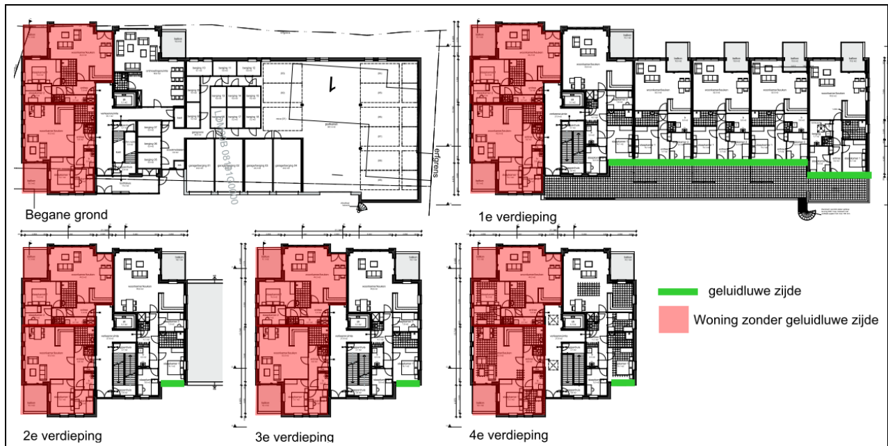
Figuur 5.1: Overzicht geluidluwe gevel
