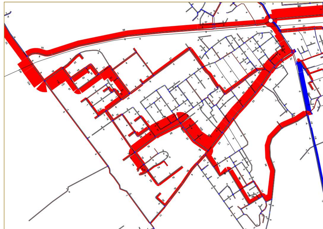
Verschilplot 2030 avondspits uurwaarden. Rood = meer verkeer scenario 1. Blauw = meer verkeer scenario zonder Broekgraaf.
