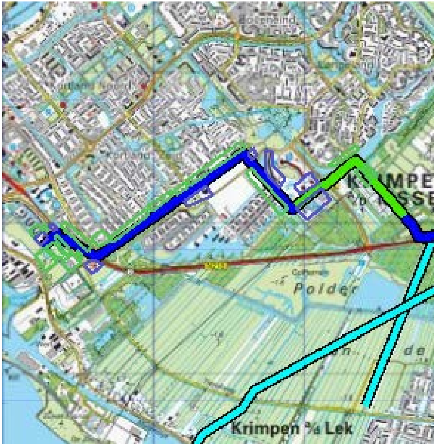
Figuur 5.2 Kilometer leiding (in groen) behorende bij de maximale overschrijding van de FN-curve voor W-513-02 van N.V. Nederlandse Gasunie
