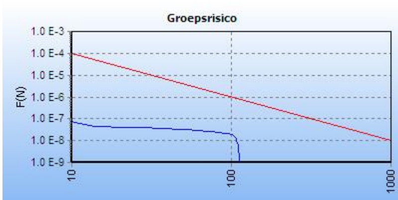
Figuur 5.2 FN curve voor 399_leiding-W-535-01-deel-1 van N.V. Nederlandse Gasunie voor de kilometer tussen stationing 2520.00 en stationing 3520.00
