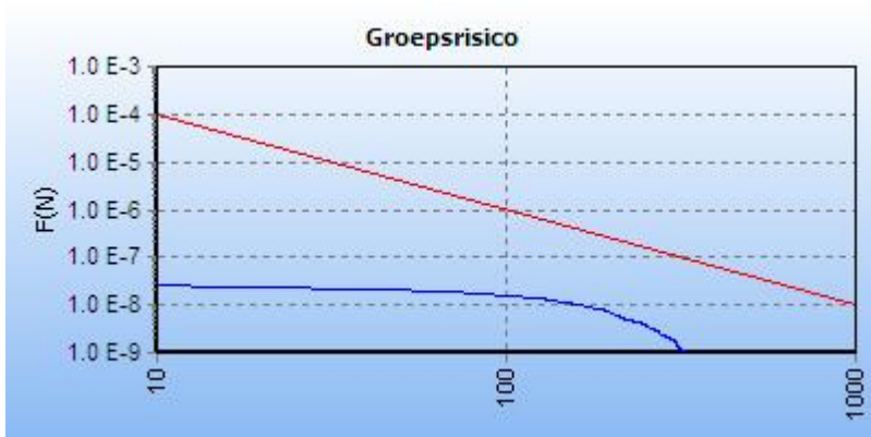
Figuur 5.2 FN curve voor 399_leiding-W-535-01-deel-1 van N.V. Nederlandse Gasunie voor de kilometer tussen stationing 2520.00 en stationing 3520.00
