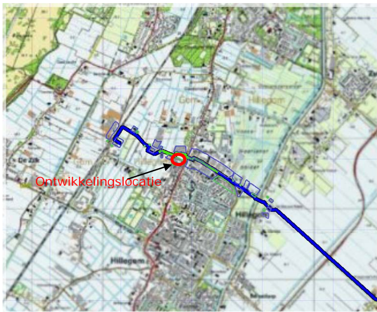
Figuur 4.3 Kilometer leiding behorende bij de maximale overschrijding van de FN-curve voor W-532-12 van N.V. Nederlandse Gasunie
