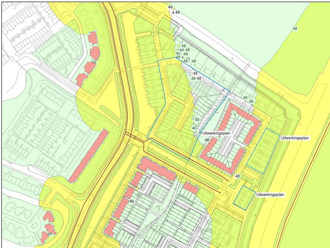
Afbeelding 6.1 – 48 dB geluidscontouren Weerlaan, Hillegommerdijk en Cruquius onder vrije veld condities, hoogte 4,8 m
