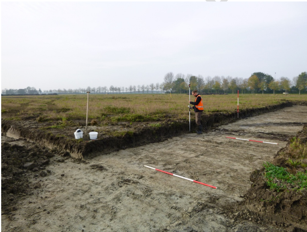
Afb. 2.1. Inmeten van de sporenvlakken met de RTS.
