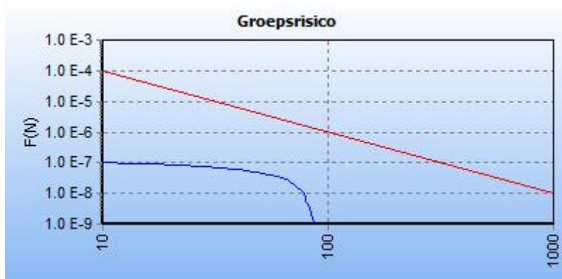
Figuur 4.4 FN-curve W-573-05-deel-1 voor de kilometer tussen stationing 4130.00 en stationing 5130.00
