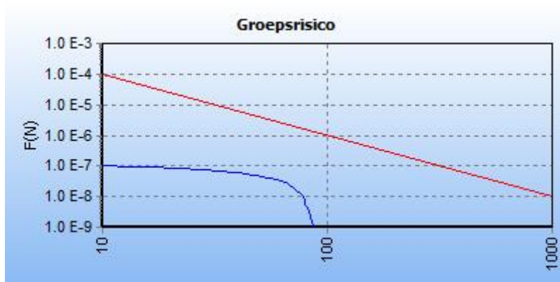
Figuur 4.7 FN-curve W-573-05 voor de kilometer tussen stationing 4130.00 en stationing 5130.00
