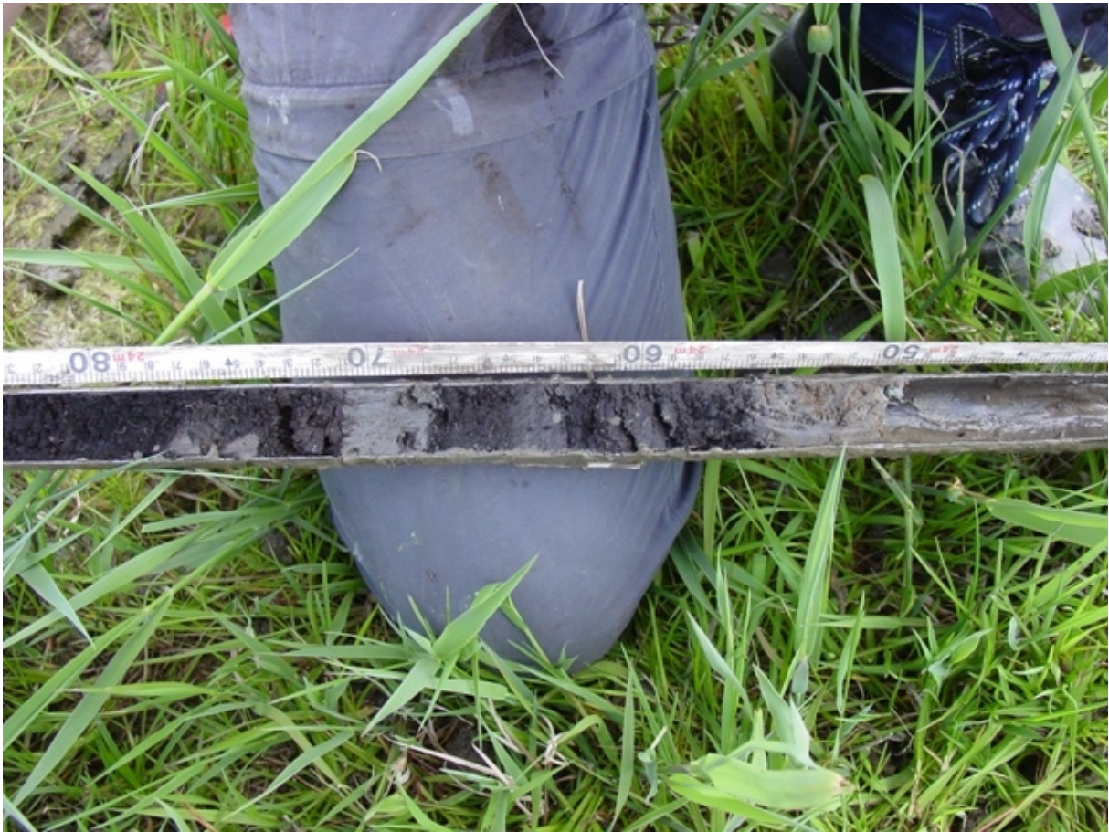
Figuur 4. Verspoelde top van het verarde veen in boring 12.
