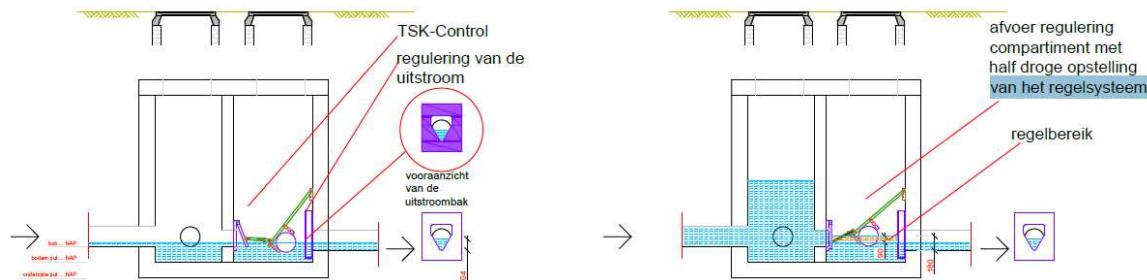
Figuur 12: Principe debietbegrenzes. Bron: AQA Hydrasep
