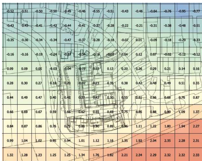
Figuur 19: Grondwatermodel Waterschap Rivierenland bij een T=10 hoogwatersituatie (Merwede).
