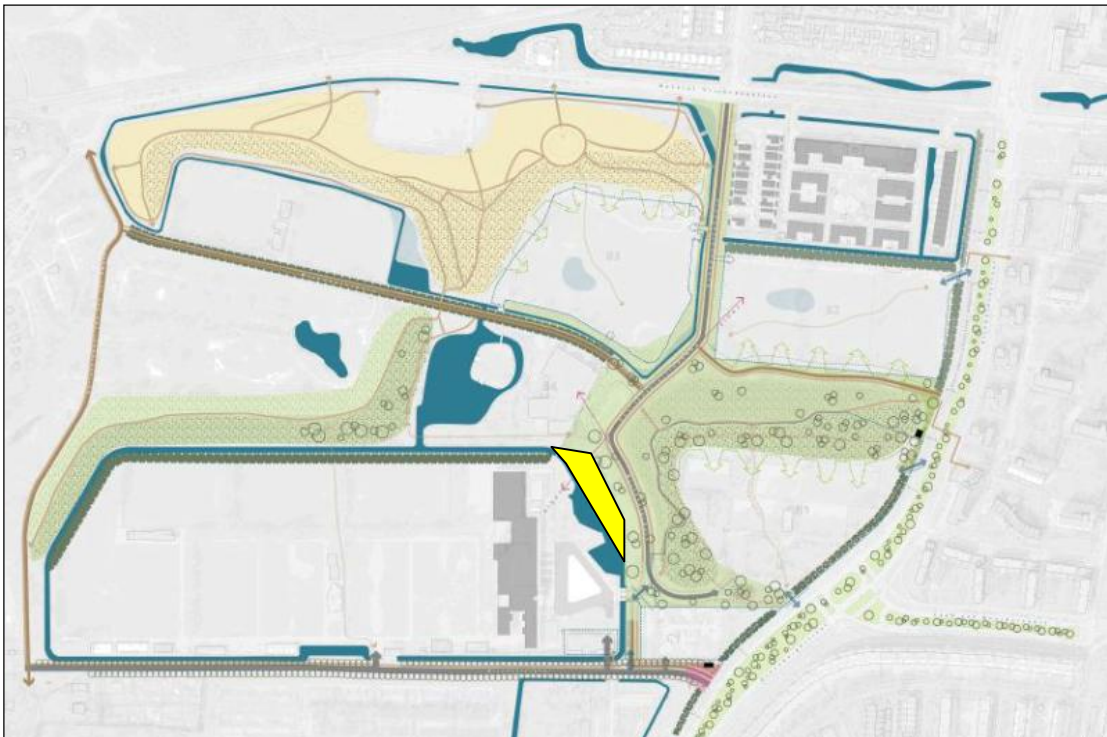
Figuur 6: Beoogde situatie voor de waterhuishouding. Ter plaatse van de gele arcering wordt de waterpartij uitgebreid [2].
