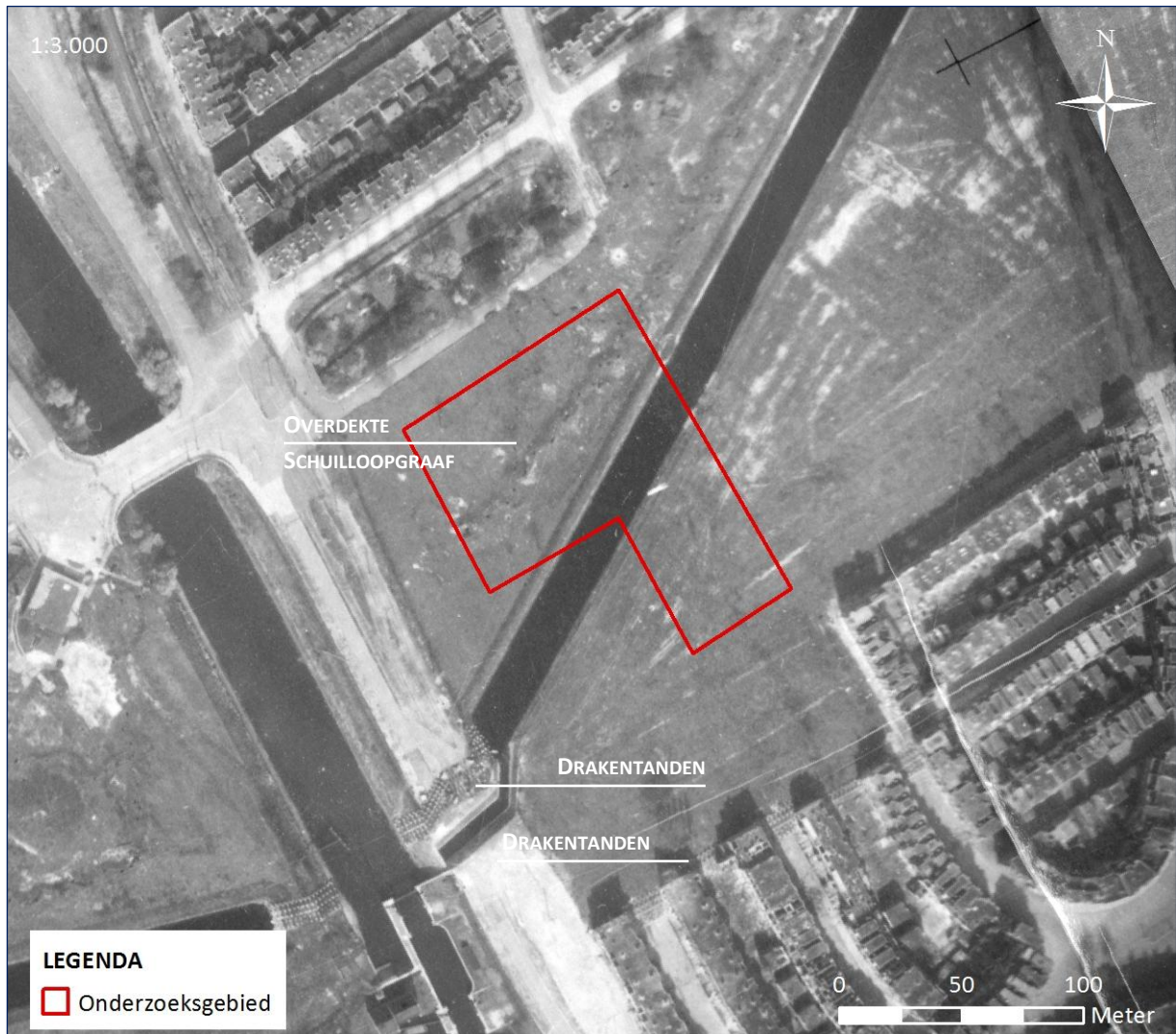
Figuur 12: Detail van een luchtopname van 18 maart 1945 op dezelfde hoogte als de voorgaande figuur. De schuilloopgraaf is inmiddels overdekt. Daarnaast zijn er 'drakentanden' waarneembaar aan de Conradkade en tussen de straten ten zuiden van de vrijgemaakte zone.
