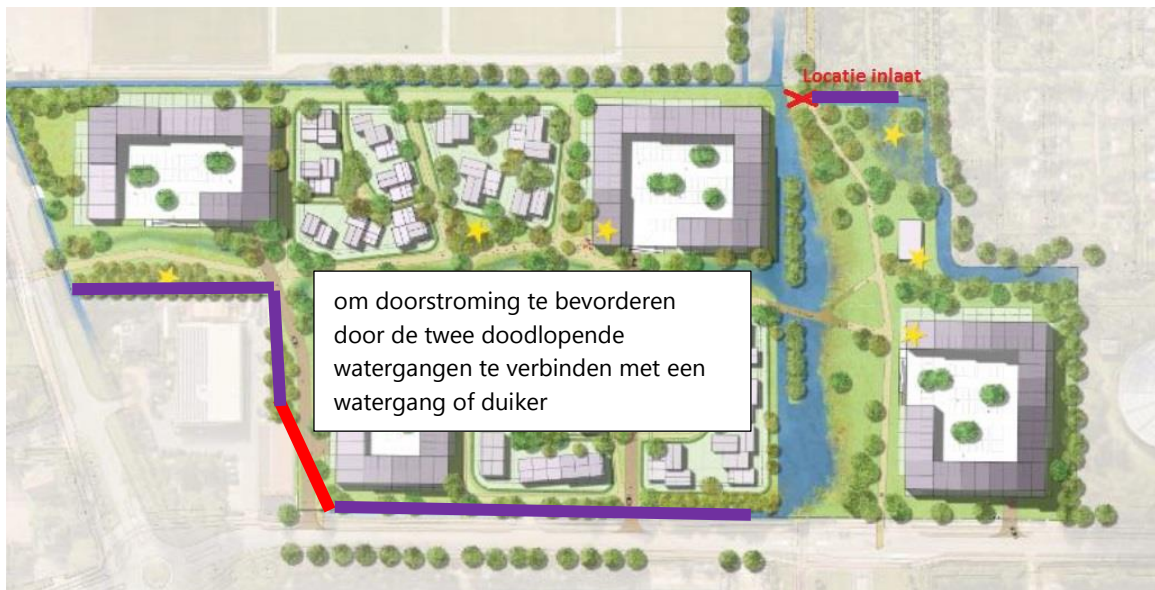
Afbeelding 4.8 Opties om de doorstroming te bevorderen in de doodlopende watergangen (paars = doodlopende watergang, rood = duiker/inlaat)
