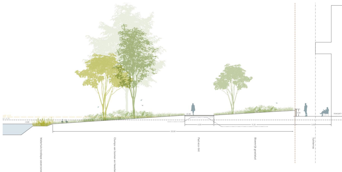
Afbeelding 4.3 Schematische doorsnede polderkade in verheeld situatie (maaiveld ligt hoger dan de minimale kruinhoogte)
