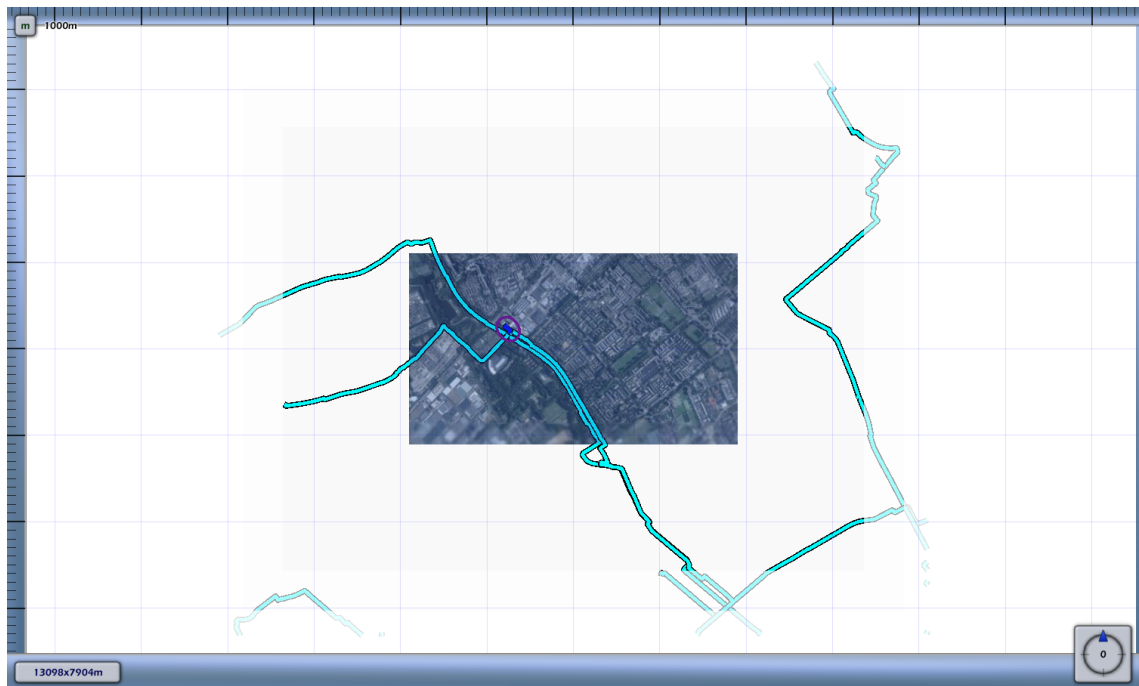
3.8 Figuur 3.8 Plaatsgebonden risico voor 6880_leiding-W-509-06-deel-1 van N.V. Nederlandse Gasunie
