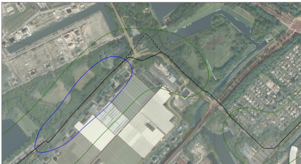
Figuur 2. PR-contouren aardgasleiding W-509-02 bestaande situatie
