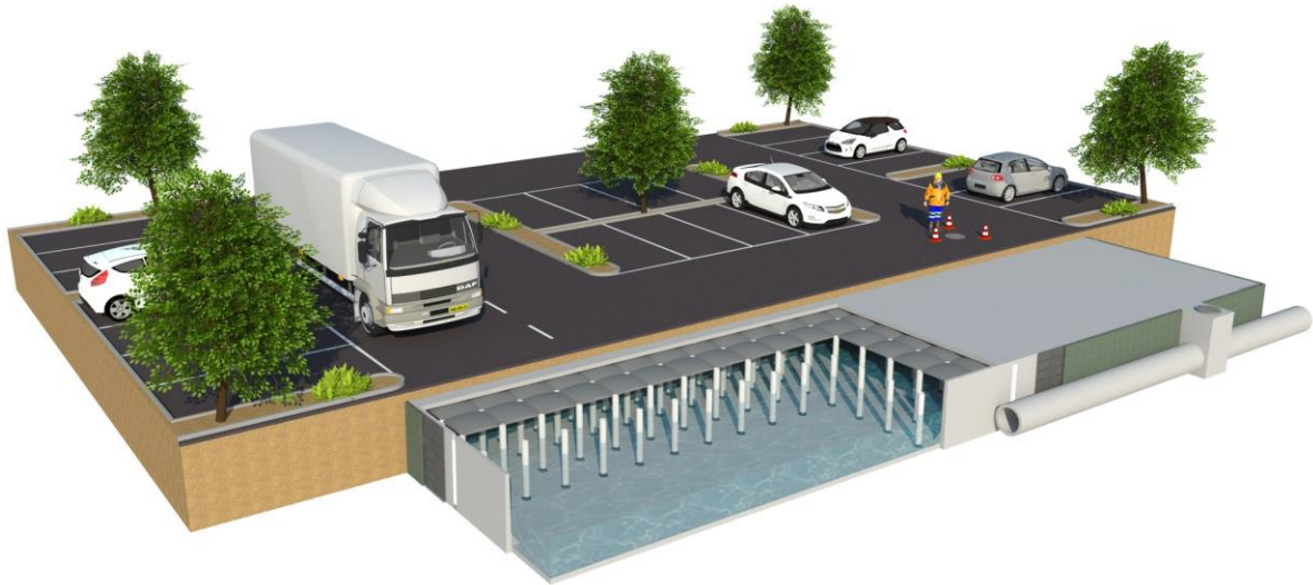
Figuur: Opengewerkte infiltratiekelder
