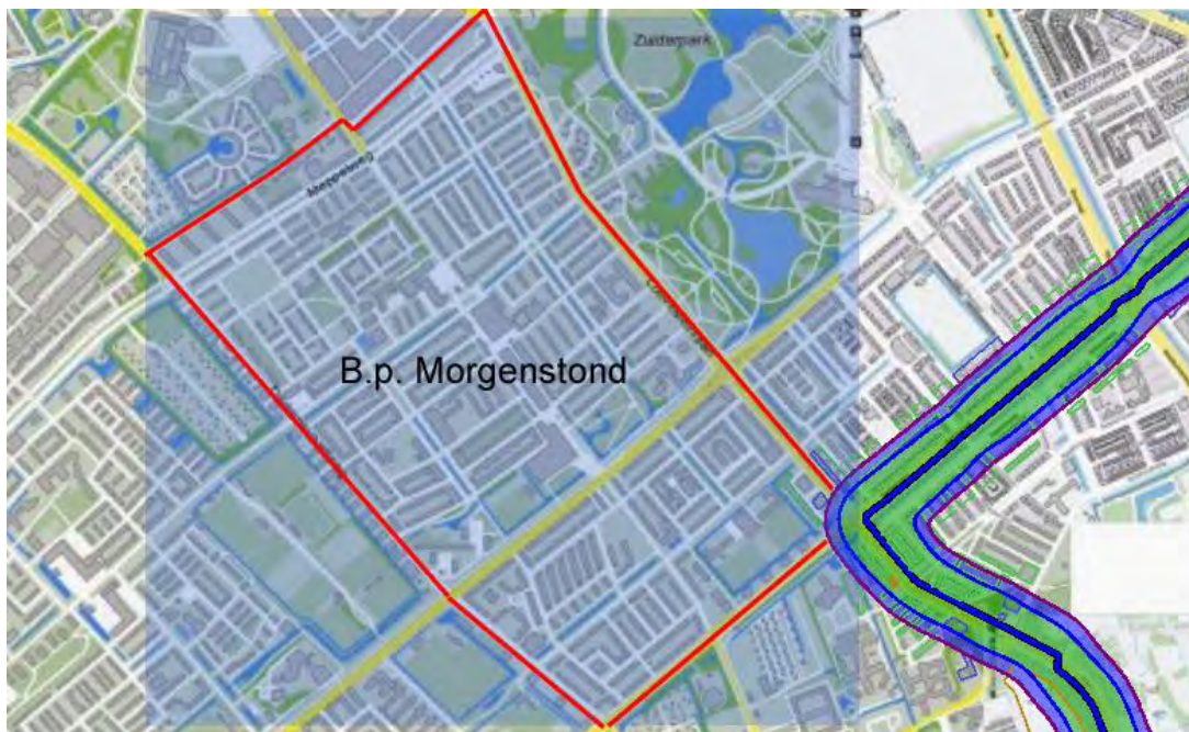
Figuur 2, weergave van het plaatsgebonden risico langs de aardgasleiding met kenmerk W-509-06. Binnen de paarse contour (blauw ingekleurd) is het plaatsgebonden risico kleiner dan 10^{-8} , binnen de blauwe contour (groen ingekleurd) kleiner dan 10^{-7} .
