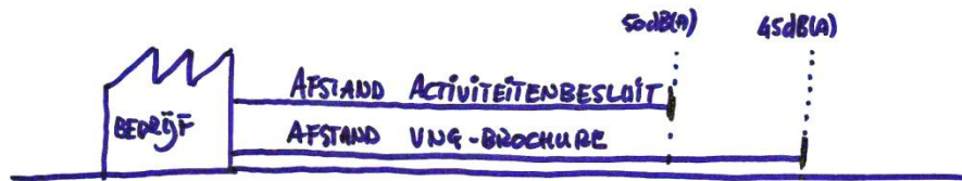
Figuur 4, illustratie van de wijze waarop de richtafstanden uit de VNG-brochure zijn aangepast ten behoeve van het voorliggende onderzoek
