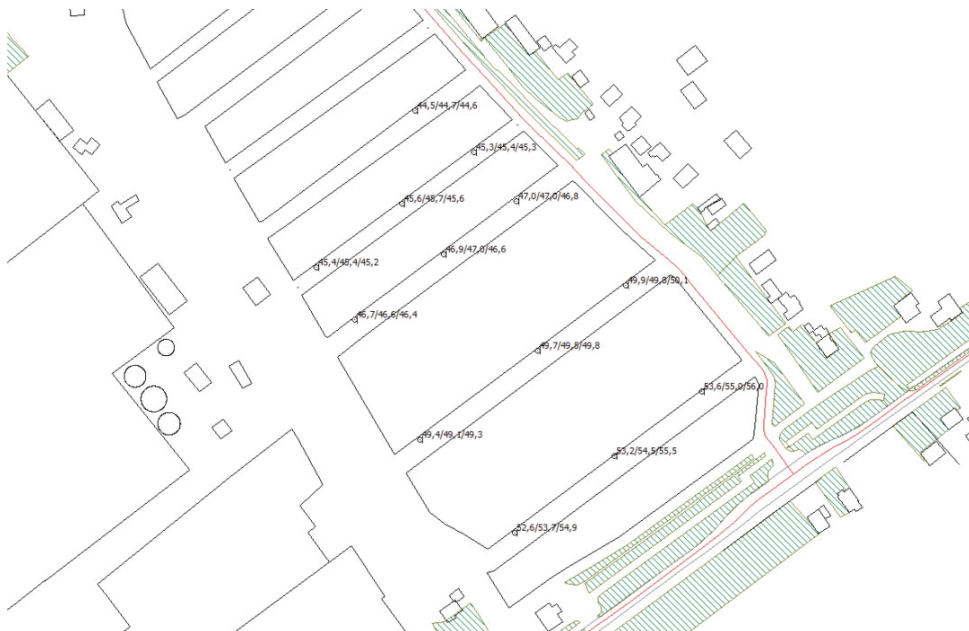
Figuur 6, Weergave berekende niveaus zonder afschermdende werking opstallen.
