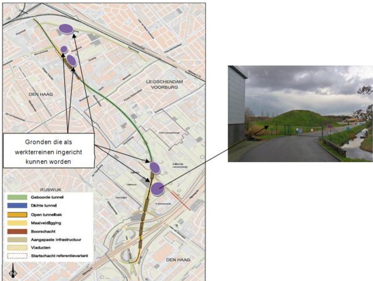
figuur 15.4 Locaties werkterreinen Rotterdamsebaan
