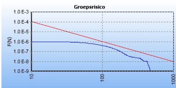
Figuur 11: FN curve van de kilometer met de hoogste overschrijdingsfactor (0,4) van de W-509-06 voor scenario 1. De ligging van de kilometer met de hoogste overschrijdingsfactor is hiernaast in het groen weergegeven op een topografische kaart.
