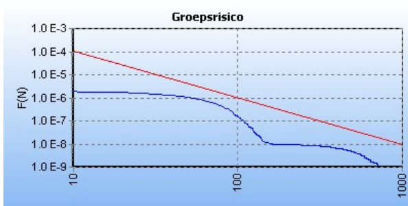
Figuur 7: FN curve van de kilometer met de hoogste overschrijdingsfactor (0,3) van de W-509-06 in de bestaande situatie. De ligging van de kilometer met de hoogste overschrijdingsfactor is hiernaast in het groen weergegeven op een topografische kaart.
