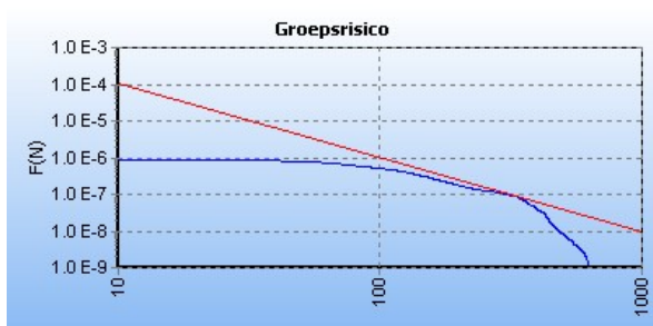
Figuur 13: FN curve van de kilometer met de hoogste overschrijdingsfactor (0,96) van de W-509-06 voor scenario 2. De ligging van de kilometer met de hoogste overschrijdingsfactor is hiernaast in het groen weergegeven op een topografische kaart.
