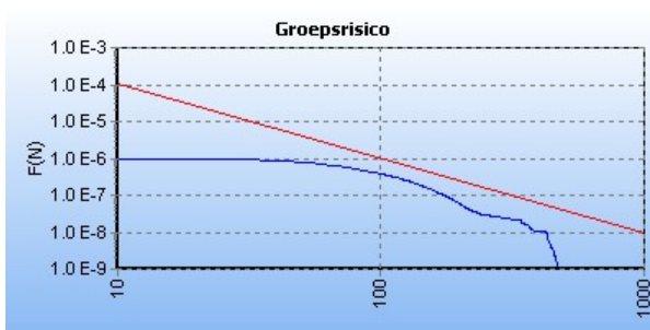
Figuur 9: FN curve van de kilometer met de hoogste overschrijdingsfactor (0,4) van de W-509-06 in de toekomstige situatie. De ligging van de kilometer met de hoogste overschrijdingsfactor is hiernaast in het groen weergegeven op een topografische kaart.
