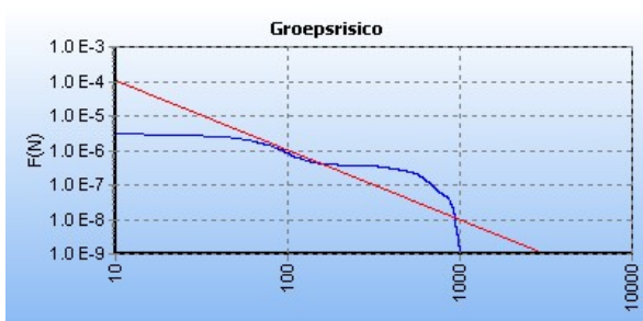
Figuur 5: FN curve van de kilometer met de hoogste overschrijdingsfactor (6,6) van de W-509-06 in de bestaande situatie zonder toepassen van saneringsmaatregelen. De ligging van de kilometer met de hoogste overschrijdingsfactor is hiernaast in het groen weergegeven op een topografische kaart.
