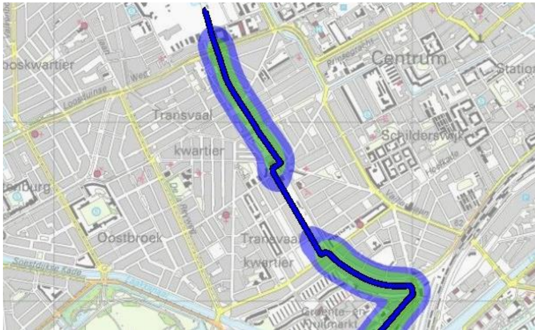
Figuur 2, weergave van het plaatsgebonden risico langs de aardgasleiding met kenmerk W-509-06. Binnen de groene contour is het plaatsgebonden risico kleiner dan 10^{-7} , binnen de blauwe contour kleiner dan 10^{-8} .
