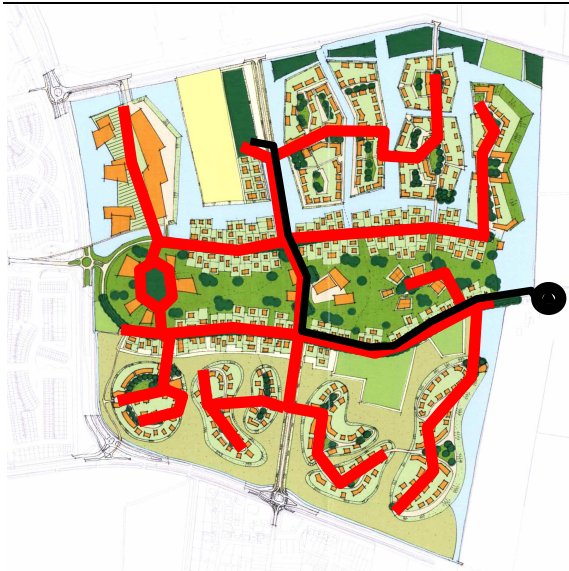
Figuur B2.1 Gemaal met persleiding richting zuivering
