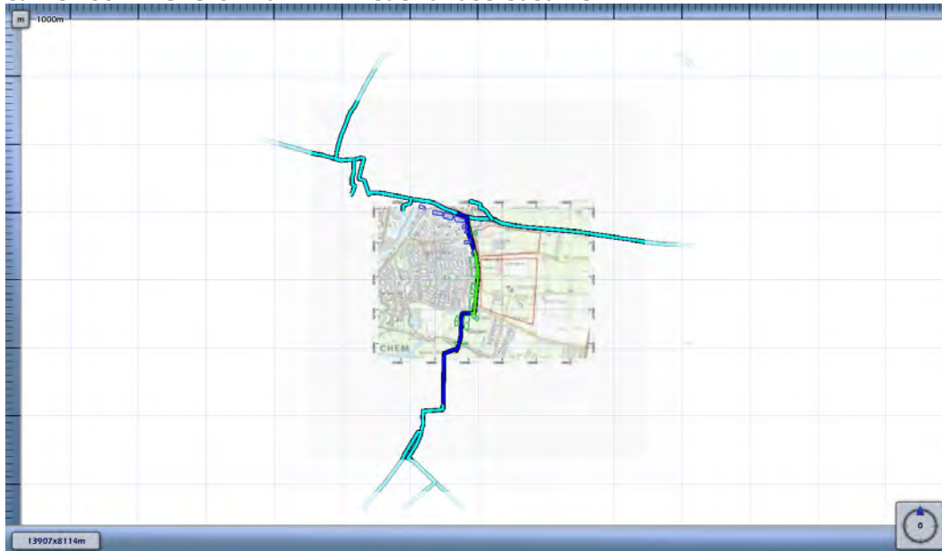
Figuur 4.10 Kilometer leiding behorende bij de maximale overschrijding van de FN-curve voor W-543-01 van N.V. Nederlandse Gasunie
