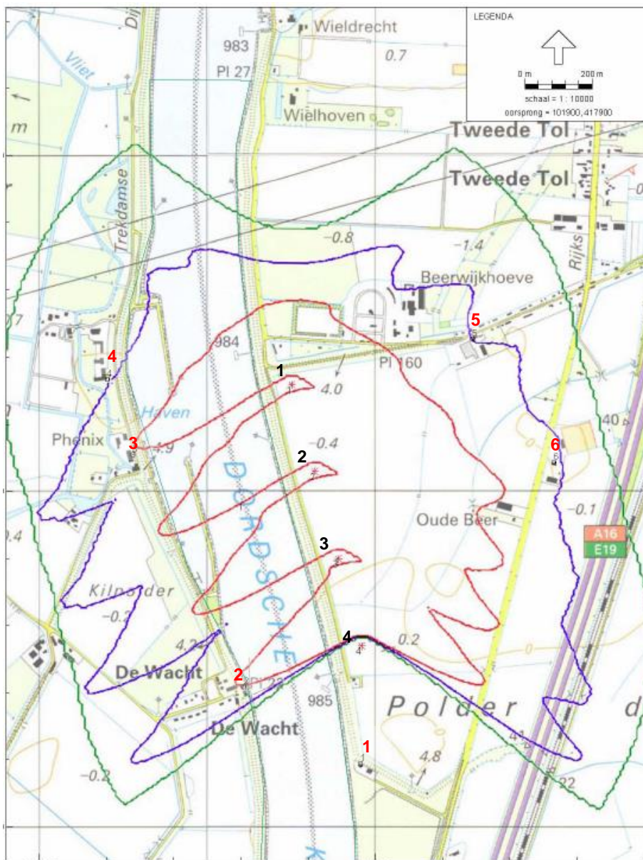
Afbeelding 6-21 Cumulatieve slagschaduwcontouren windturbines in plangebied DK IV: 0 (groen), 5 (paars) en 15 (rood) uur hinder (zwarte nrs: windturbines; rode nrs: toetspunten woningen)
