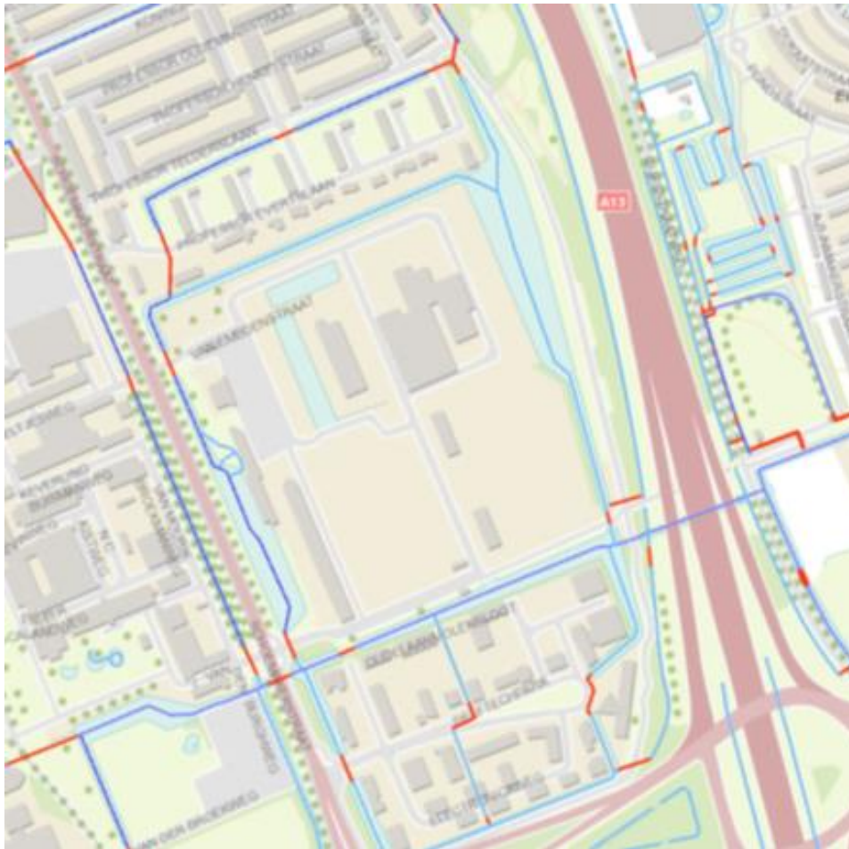
Afbeelding 2.8 Legger watergangen Hoogheemraadschap van Delfland (Lichtblauw: gewoon en buitengewoon onderhoud door Gemeente Delft. Donkerblauw en paars: gewoon en buitengewoon onderhoud door Hoogheemraadschap van Delfland)
