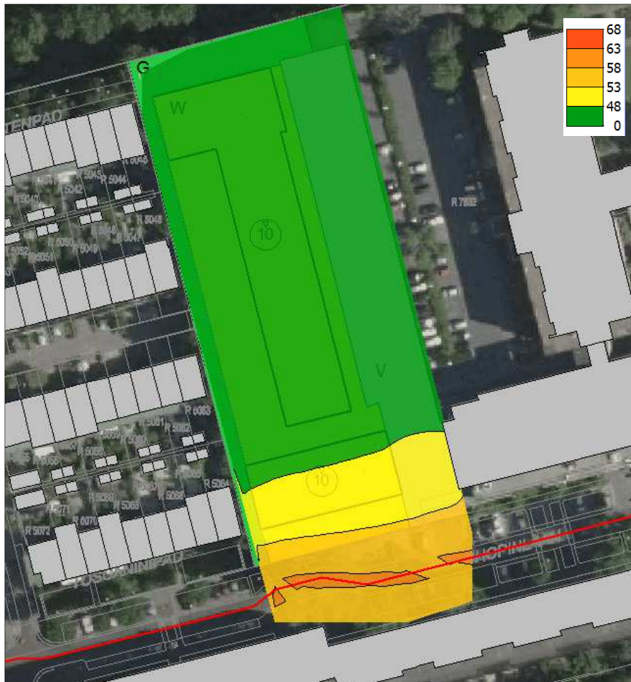
Figuur 4.2: Geluidscontouren ten gevolge van de Chopinlaan, waarneemhoogte 7,5 m, zonder correctie conform artikel 110g Wgh
