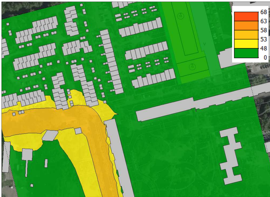
Figuur 4.1: Impressie van de geluidscontour ten gevolge van de route Mozartlaan - Beethovenlaan, waarneemhoogte 7,5 m, inclusief correctie conform artikel 110g Wgh
