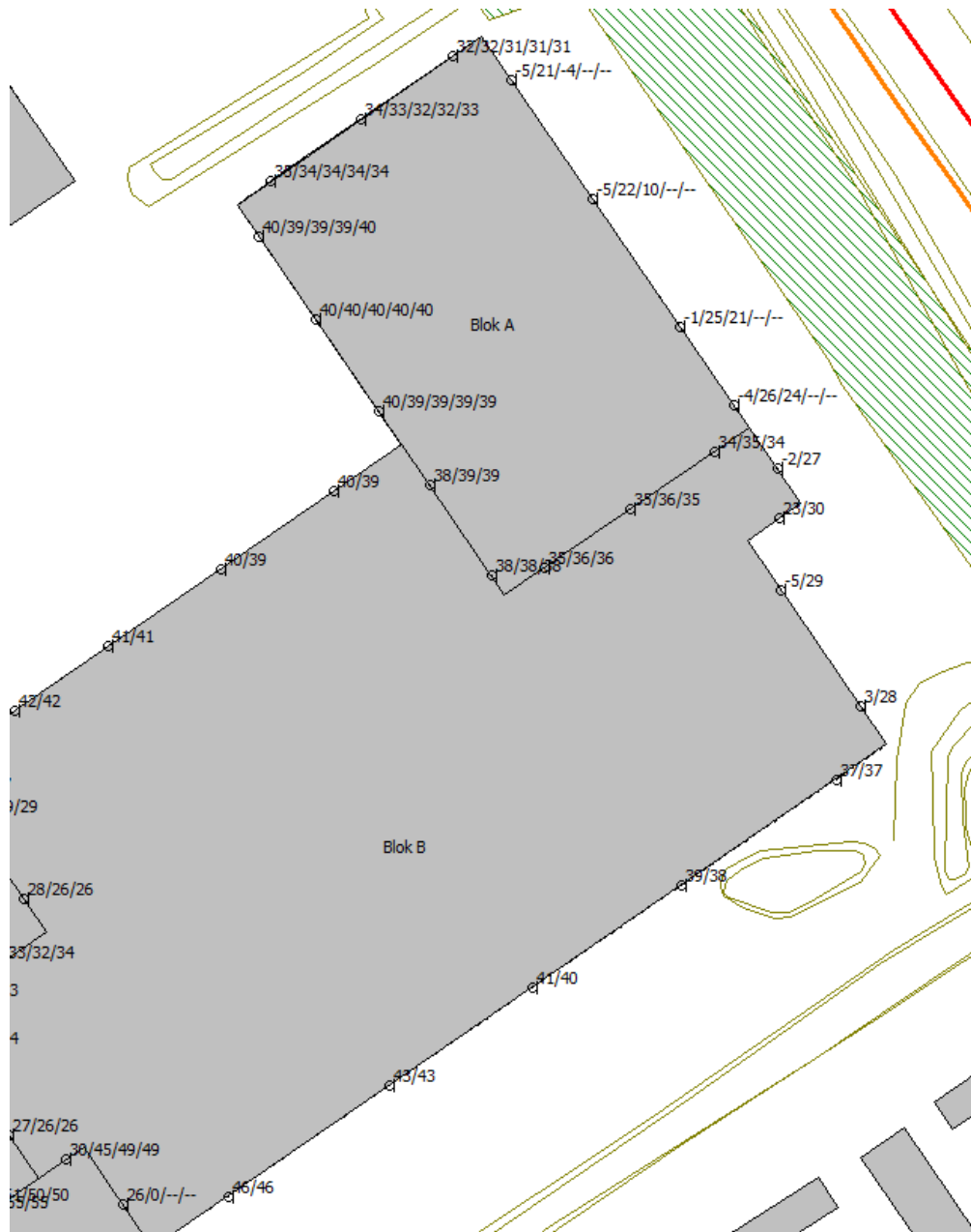
Figuur 4.1.4 Geluidsbelasting ten gevolge van het verkeer op de Sint Jorisweg/Van Miereveltlaan inclusief aftrek conform artikel 110g Wgh
