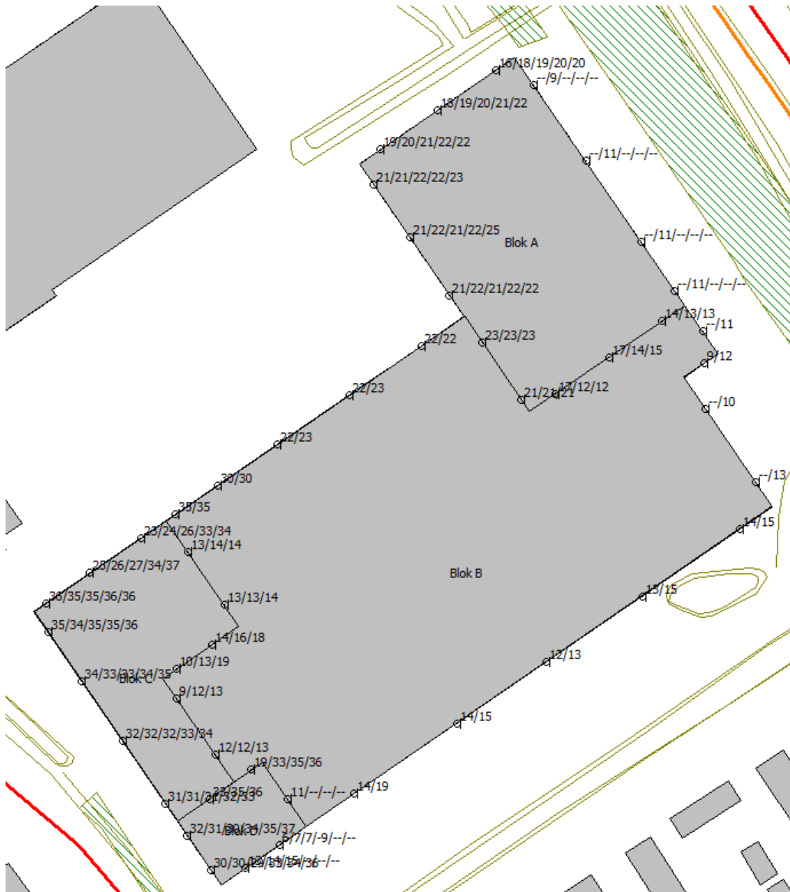
Figuur 4.1.5 Geluidsbelasting ten gevolge van het verkeer op de Bonairestraat inclusief aftrek conform artikel 110g Wgh
